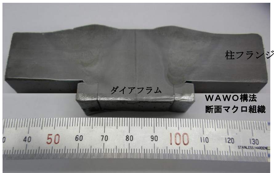
図1 WAWO構法と従来工法の柱溶接継手溶接量の重ね合わせ比較(断面)
