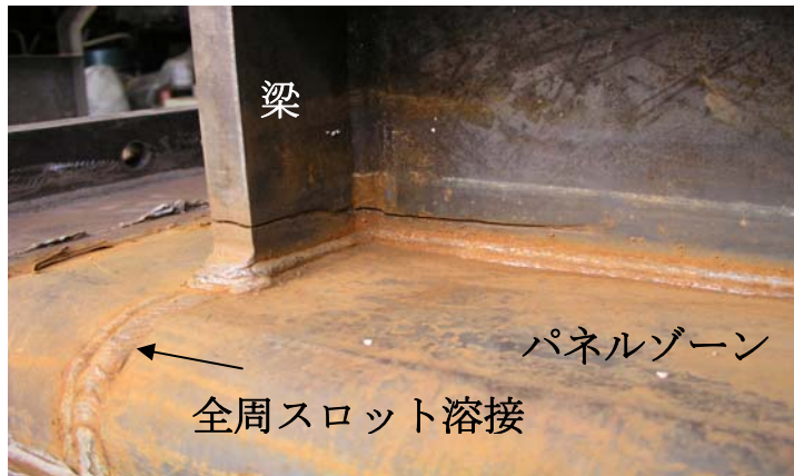
図 4. 5. 3 ロット方式の実大 T 形破壊試験体の破断状況
