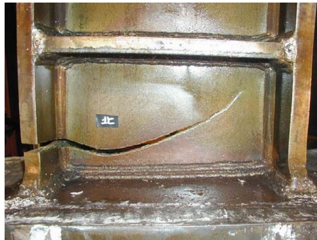
図 4. 2. 3 一体化工法の T 形実大破壊試験体の破断状況
