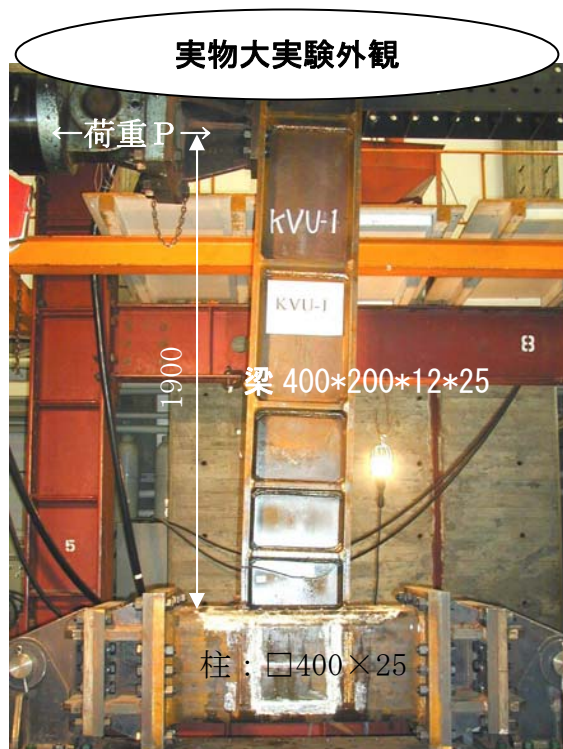
(破断箇所：梁母材部)
